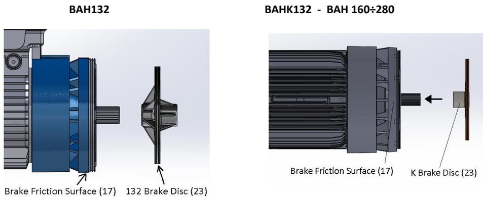
Для последующего монтажа действуйте в обратном порядке. Отрегулируйте зазор и тормозной момент, следуя инструкциям, приведенным в соответствующих параграфах.
