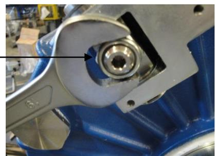
Снимите ручку разблокировки (128) с винтов разблокировки (118).
