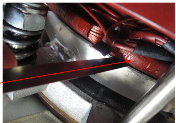
**Диапазон значений зазора для размера двигателя**
