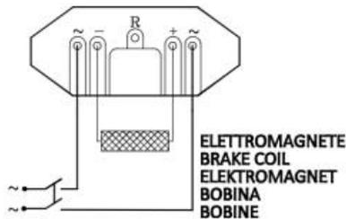
**FRENATA RAPIDA - QUICK BRAKING - SCHNELL BREMSVORGANG**
