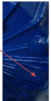
После удаления пробок закрутите два винта разблокировки (131).
