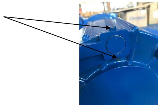
Крепежная гайка рычага (129)
