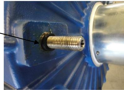
Per riassemblare procedere a ritroso. Nel montaggio della maniglia di sblocco, fare attenzione a lasciare un traferro tra maniglia e cuffia.
