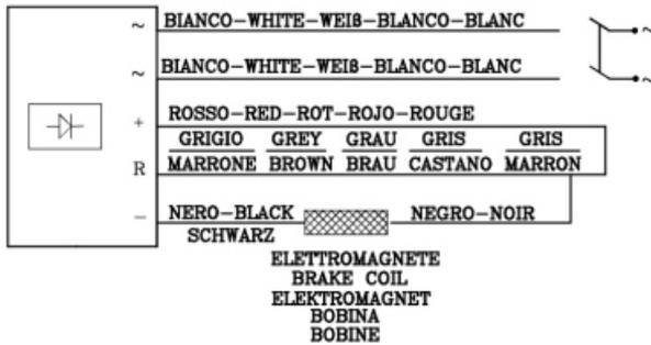
FRENATA RAPIDA - QUICK BRAKING - SCHNELL BREMSVORGANG
